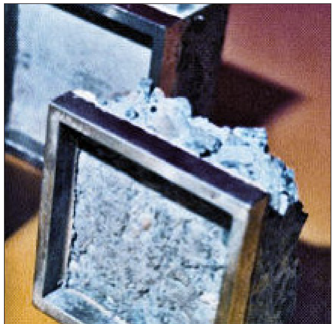
3. ábra: Sósavoldat hatása a bazalt zúzottkő adalékanyagú betonra (Kausay et al. 1986)
